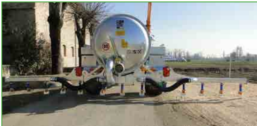
Barra idraulica VAIA di scarico da m. 6 (14 discese)
