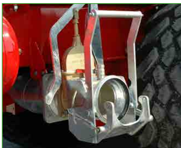
Sarac. inferiore laterale con attacco rapido manuale D. 6"
