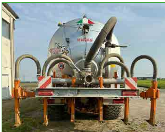
Interratore telescopico 6 ancore
