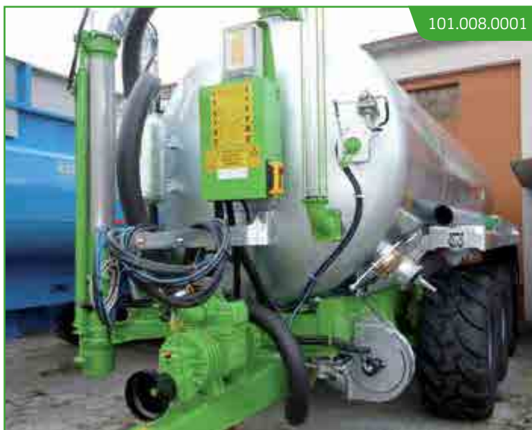
Acceleratore di carico su braccio laterale montato sul lato opposto
