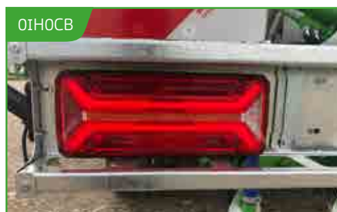
Fari posteriori a Led con freccia dinamica
