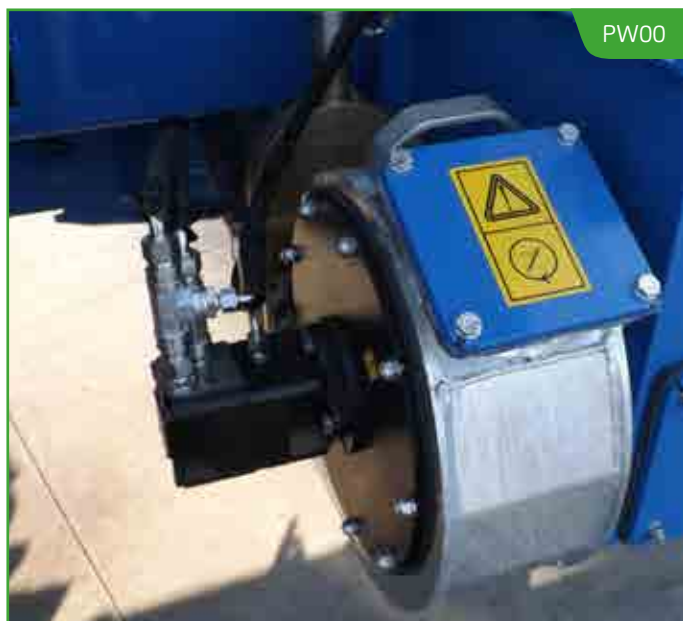
Acceleratore di carico per braccio laterale con seconda entrata
