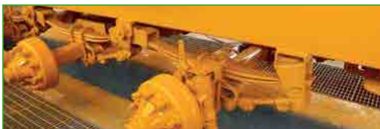
Sospensione tandem e tridem registrabili
