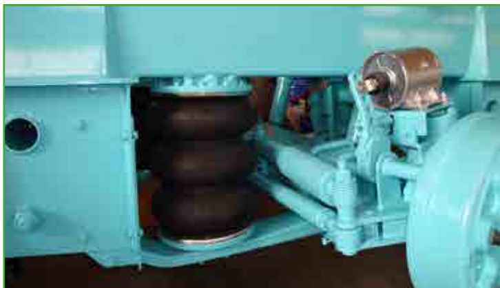
Impianto freno pneumatico con sospensione pneumatica
