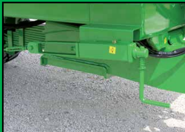
Freno Parking meccanico tipo Italia per biassi Mechanische parkeerrem type Italië voor dubbele as Italian-type mechanical parking brake for dual axles Frein de stationnement mécanique type Italie pour double essieu Mechanische Feststellbremse Typ Italien für Doppelachser
