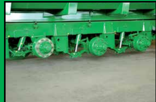
Sospensione Tridem Idraulica Hydraulische Tridem-ophanging Hydraulic Tridem suspension Suspension Tridem Hydraulique Hydralische Tridemaufhängung
