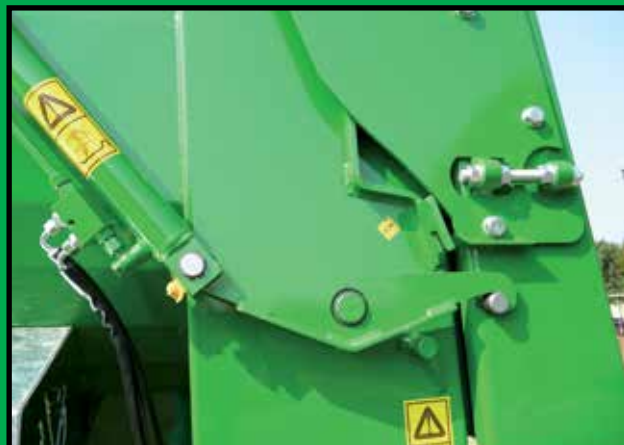
Partic. Porta idr. con gancio meccanico di blocco Detail hydraulische deur met mechanische blokkeringshaak Detail of hydraulic gate with mechanical clamp Détail de la porte hydraulique avec enclenchement mécanique de verouillage Detail der Hydrauliktür mit mechanischem Befestigungshaken
