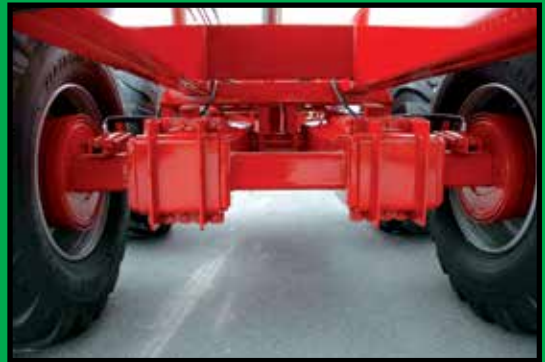
Sospensione bilanciere rigido a 24 T Steife kippaufhängung 24 T Suspension rigid beam-engine 24 T Suspension balancier rigide 24 T Star tandemstel 24 T
